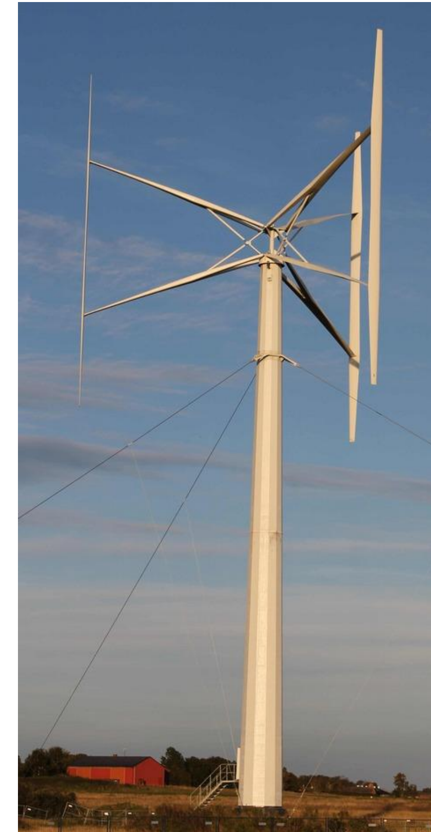
Abb.3: VAWT mit H-Rotor mit einer Nennleistung von 200 kW. 4
